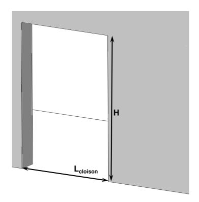
L<sub>cloison</sub> = 1000 pour une porte de largeur 1030 L<sub>cloison</sub> = 900 pour une porte de largeur 930
